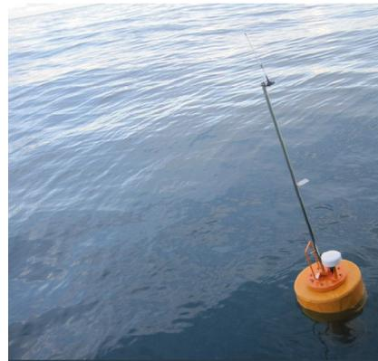
圖 5 現場試驗使用之 GPS 漂流浮標
