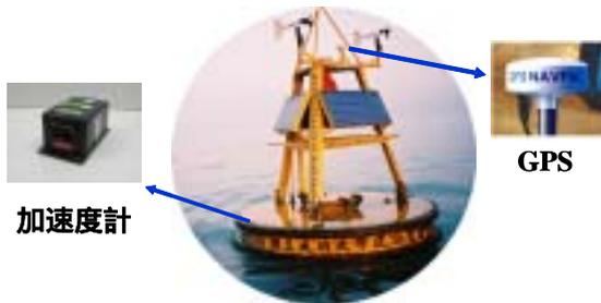
圖 1. 2.5m 碟型浮標測計裝置
