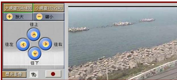
圖3 現場即時影像監控畫面—本例為高雄蚵仔寮海岸即時影像，圖中顯示可以提供遠端遙控鏡頭拉伸、轉動、錄影之功能
