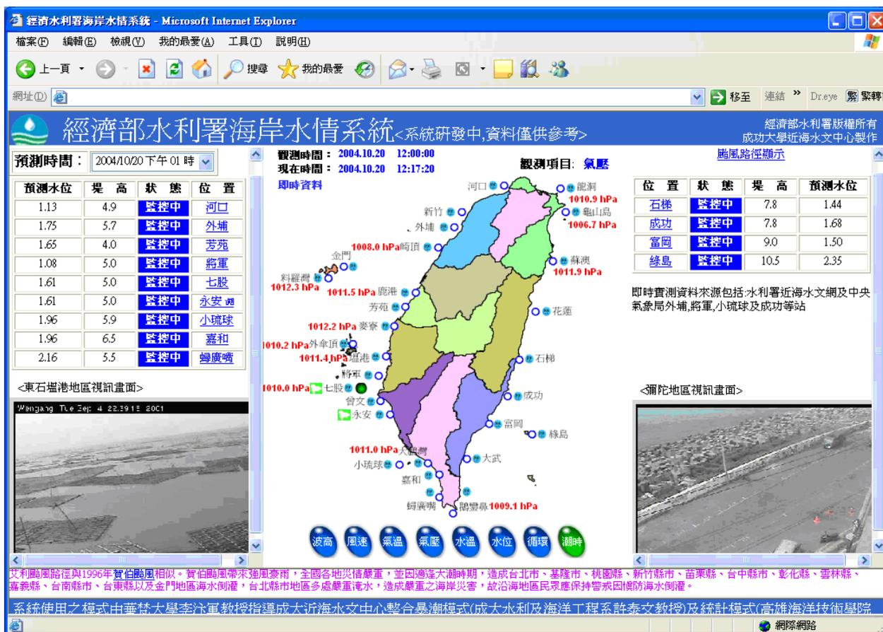
圖4 因應海岸溢淹災害監測與預警所建置之海岸水情系統主畫面
