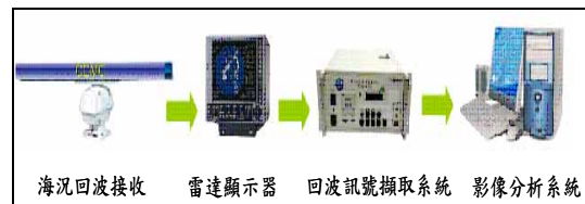
圖 1 X-band 雷達觀測系統流程圖。
