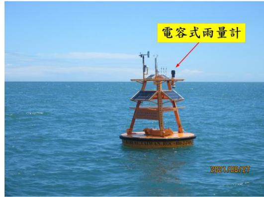
圖3 2021年8月27在富貴角浮標進行實海域雨量觀測作業
