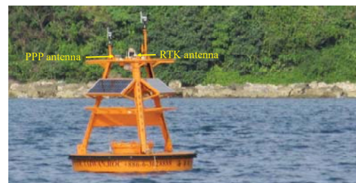
圖 2 南灣浮標 PPP 與 RTK 天線盤安裝外觀圖
