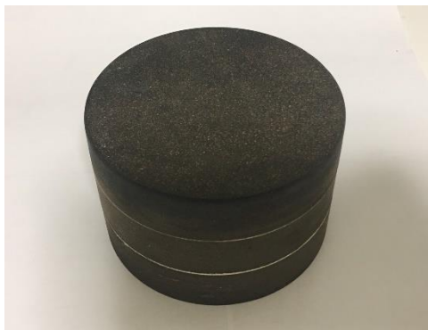
圖 10 橡膠多孔材料試片，直徑為 11.52 cm、厚度 6.53 cm
