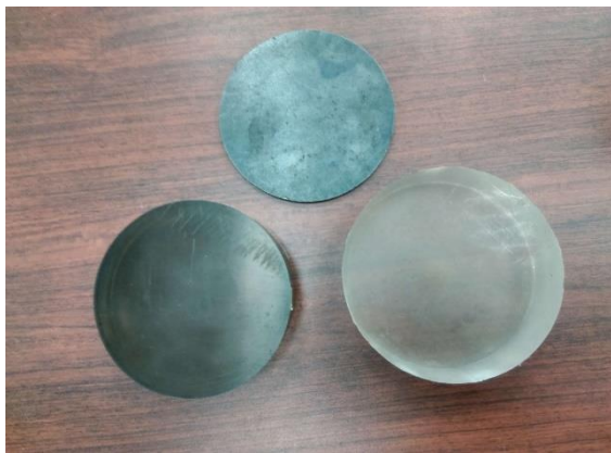
圖 12 三種單一材料水中反射係數量測試片；鋼板(上)、聚氨酯膠(左下)、及矽膠(右下)
