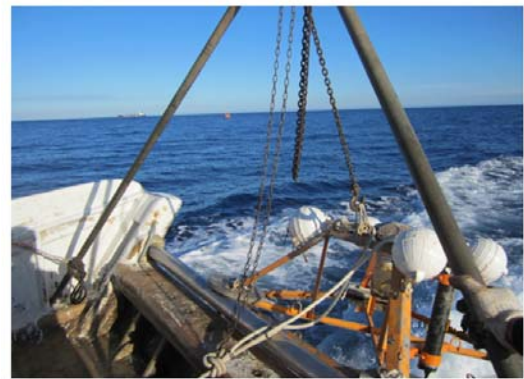
照片 2 底碇式流速儀下水進行觀測
