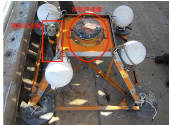
照片 1 底碇式流速儀設備配置
