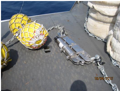
圖 4：連接玻璃浮球及鐵鍊
