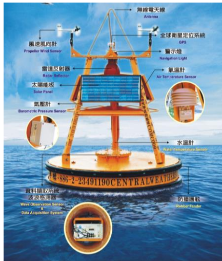
圖 1：資料浮標觀測系統示意圖
