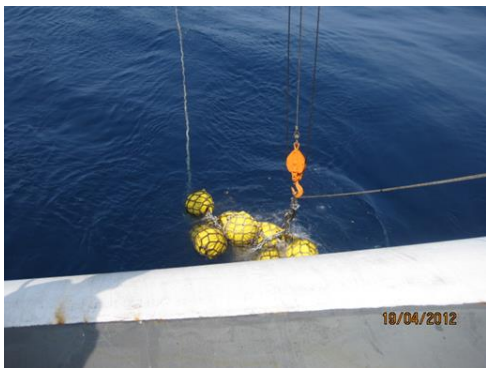
圖 5：玻璃浮球用脫鈎器脫鈎下水
