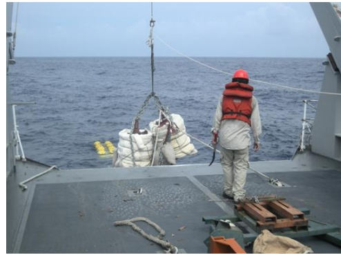
圖 6：準備脫鈎及割斷錨錠固定繩索
