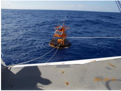
圖 7：浮標套上兩條拖曳繩準備進行直接回收
