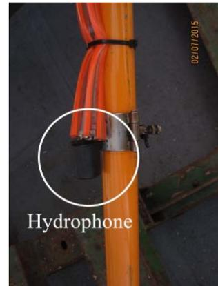
圖 4 水下麥克風及套管
