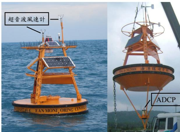
圖10 海氣象資料浮標上之超音波風速計及ADCP
