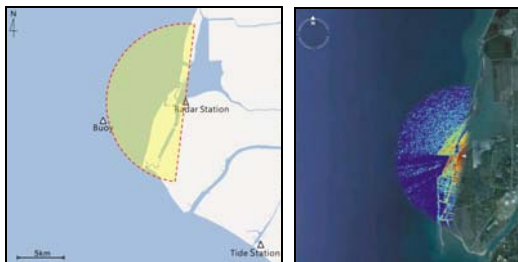
圖 1 現場實驗布置(右圖)與雷達影像套疊圖(左圖)
